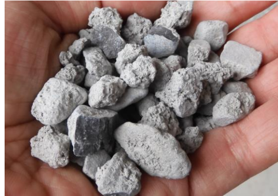
写真2 粒状化再生骨材 (CO 2 固定後)
